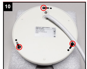
Auf der Unterseite der Kamera befinden sich drei Löcher.
