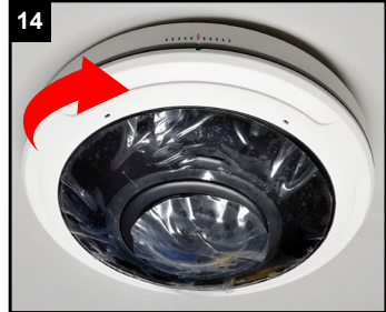
14 Weißen Kunststoff-Ring im Uhrzeigersinn wieder auf die Kamera schrauben.
