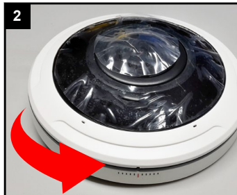
Weißer Kunststoff-Ring der Kamera durch Drehen entgegen dem Uhrzeigersinn lösen.
