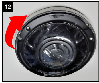
12 Kamera im Uhrzeigersinn drehen, bis sie von den drei Schrauben gehalten wird.
