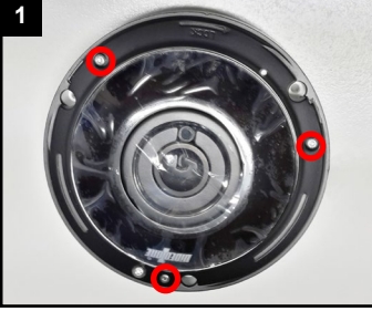
1 Die drei Schrauben unter der weißen Abdeckung lösen.
