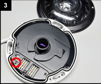
3 Für Reset: Fünf Sekunden lang die Taste gedrückt halten.
