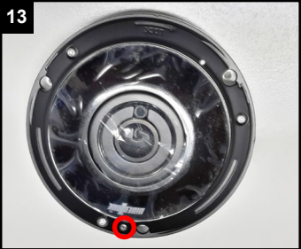
13 Feststell-Schraube anziehen und Halt prüfen.
